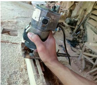
Gambar 24. Proses Pembuatan Sambungan *Tongue & Groove*
