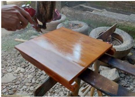
Gambar 30. Proses Pelapisan *Top Coat NC Doff* Lapis Pertama
