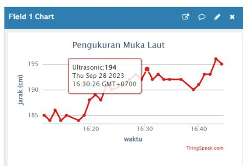
Gambar 5. Hasil Pemantauan Muka Air Menggunakan Sensor Ultrasonic
