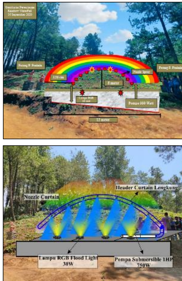
Gambar 1. Desain dan Rancang Bangun Set Rainbow Waterfall a) Konstruksi Rainbow Waterfall dan b) Instalasi Teknologi Rainbow Waterfall
